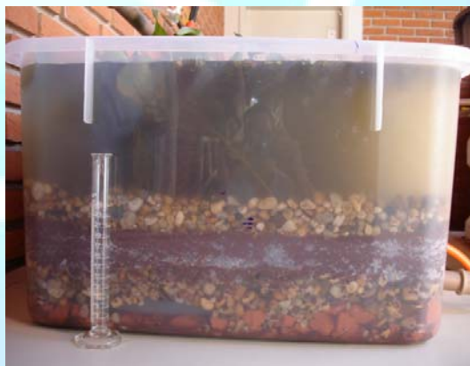
Figura 4. Detalhe das camadas que compuseram os sistemas dos tratamentos 1 e 2. Vista lateral do sistema montado, demonstrando a saída do efluente da simulação de piscicultura que foi distribuído para os tanques de tratamento.
