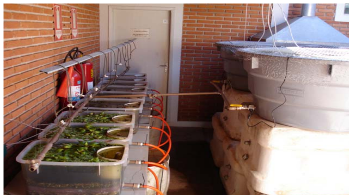
Figura 5. Vista lateral do sistema montado, mostrando a saída do efluente da simulação de piscicultura que foi distribuído para os nove tanques de tratamento.
