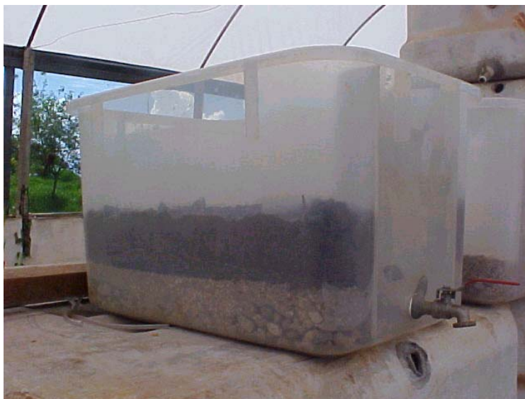
Figura 2. Tanque utilizado nos experimentos contendo as camadas de seixos e solo.
