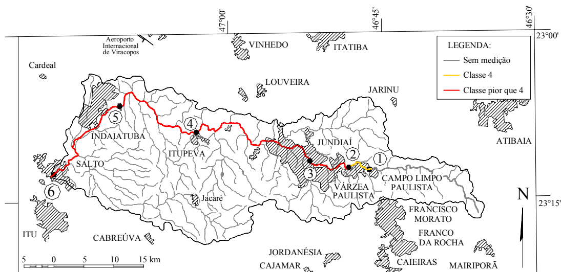
(a) Situação do rio Jundiá antes da construção da ETE-Jundiá.
